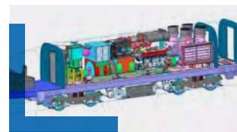
Pour un assemblage tel que ce gros moteur de train conçu avec Creo, un modèle squelette peut définir l'intention de conception et la structure du produit. Les définitions maîtresses de la géométrie du squelette permettent l'intervention simultanée de plusieurs concepteurs sur les détails.
